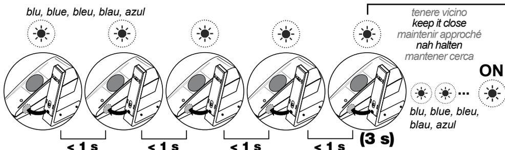
**IT** - Avvicinare il magnete di programmazione al sensore **5 volte** e tenere vicino.
