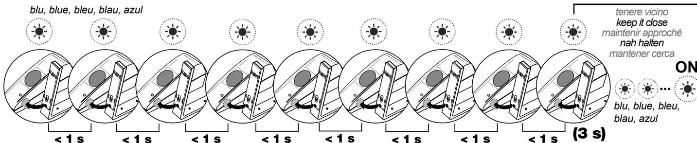
**IT** - Avvicinare il magnete di programmazione al sensore **9 volte** e tenere vicino.
