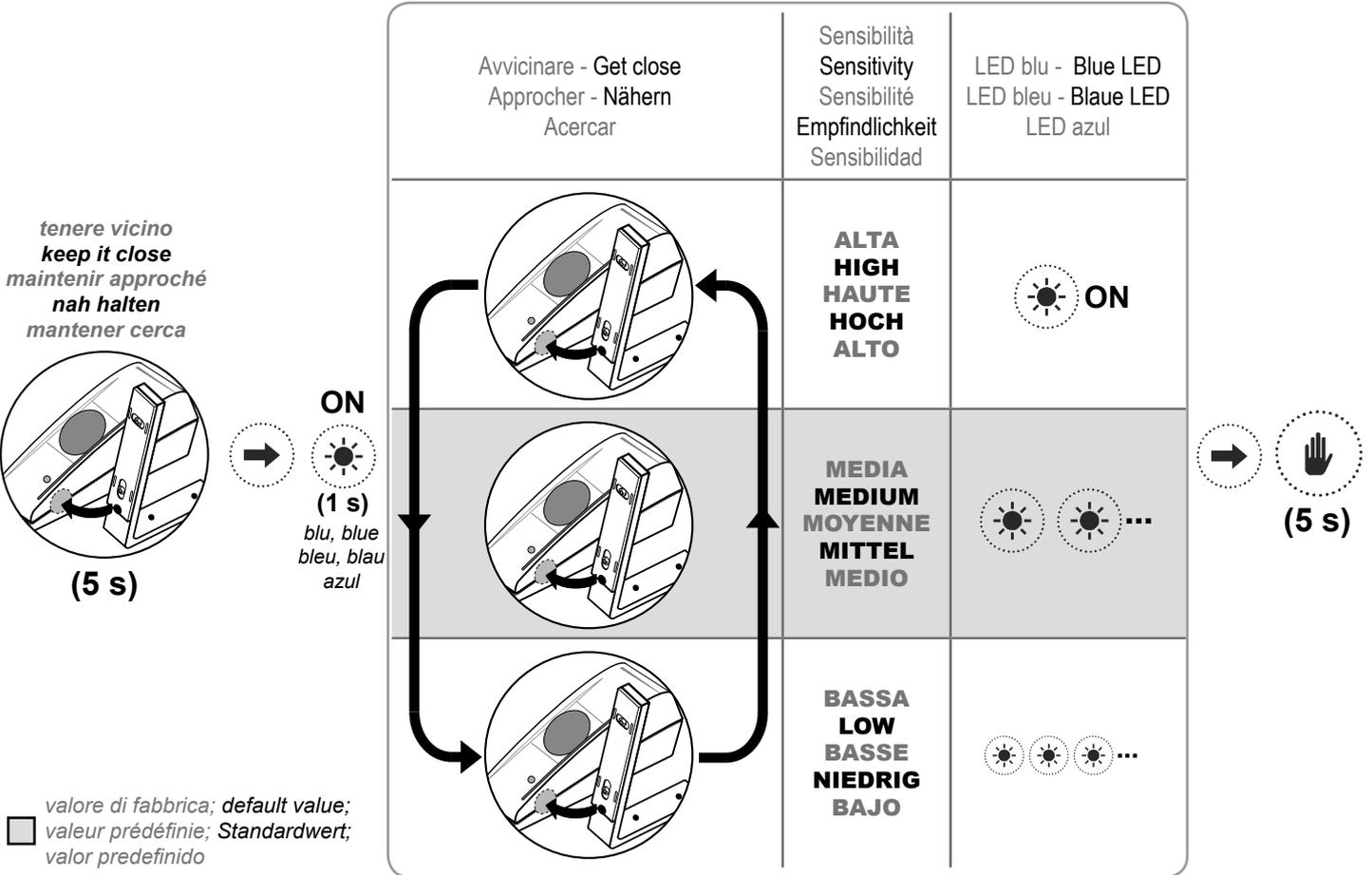
IT - Avvicinare il magnete di programmazione al sensore e tenere vicino per 5 s. Il LED blu si accende per 1 s. Avvicinare il magnete tante volte quante richieste per configurare la sensibilità desiderata. Attendere 5 s per salvare il nuovo valore.
