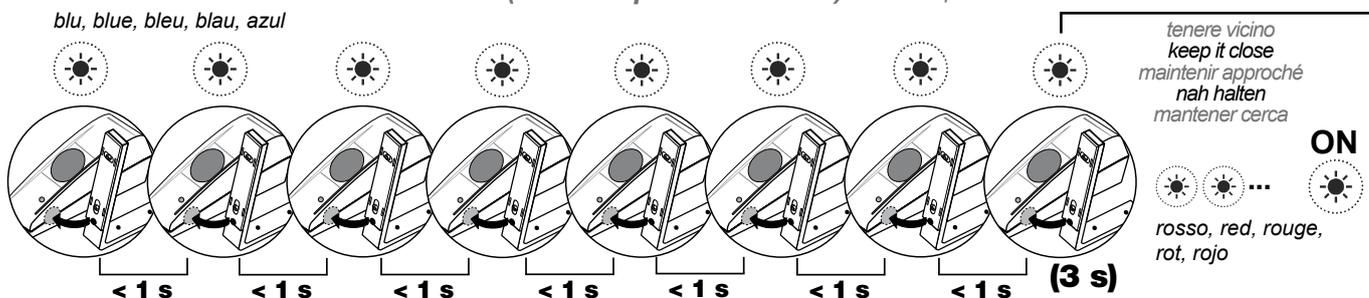
**IT** - Avvicinare il magnete di programmazione al sensore **8 volte** e tenere vicino.
