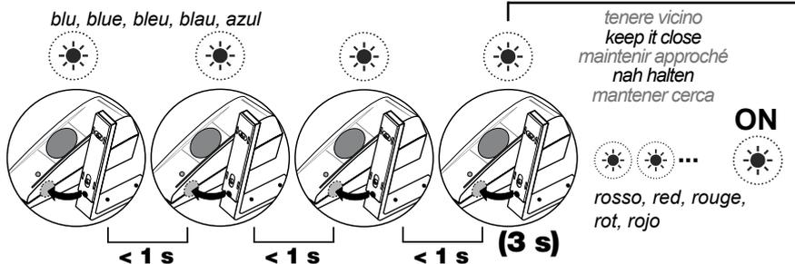
**IT** - Avvicinare il magnete di programmazione al sensore **4 volte** e tenere vicino.
